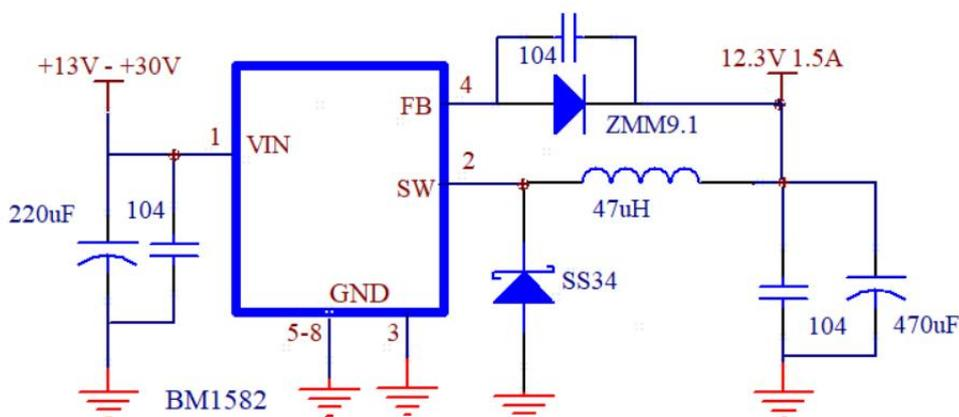
9.1V的稳压二极管可用SOD523的小封装，与贴片电阻尺寸差不多， $12.4V = 9.1V + 3.3V$
