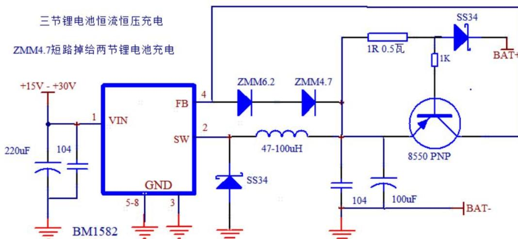
降压恒流CC恒压CV给二三节锂电池充电，输出 0.6A
